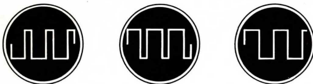
Fig. 5 Contrariamente a quanto l'allievo aveva indicato, il potenziometro R1 (da noi sostituito con un trimmer) non serve per variare la frequenza, bensì per linearizzare la forma dell'onda quadra. Con l'aiuto di un oscillografo, noi dovremo quindi regolare R1 una volta per sempre, in modo che sullo schermo la larghezza della semionda inferiore risulti perfettamente uguale a quella superiore (vedi disegno di destra). Diversamente noi otterremmo in uscita delle onde quadre simili a quelle visibili nelle due prime figure di sinistra.
