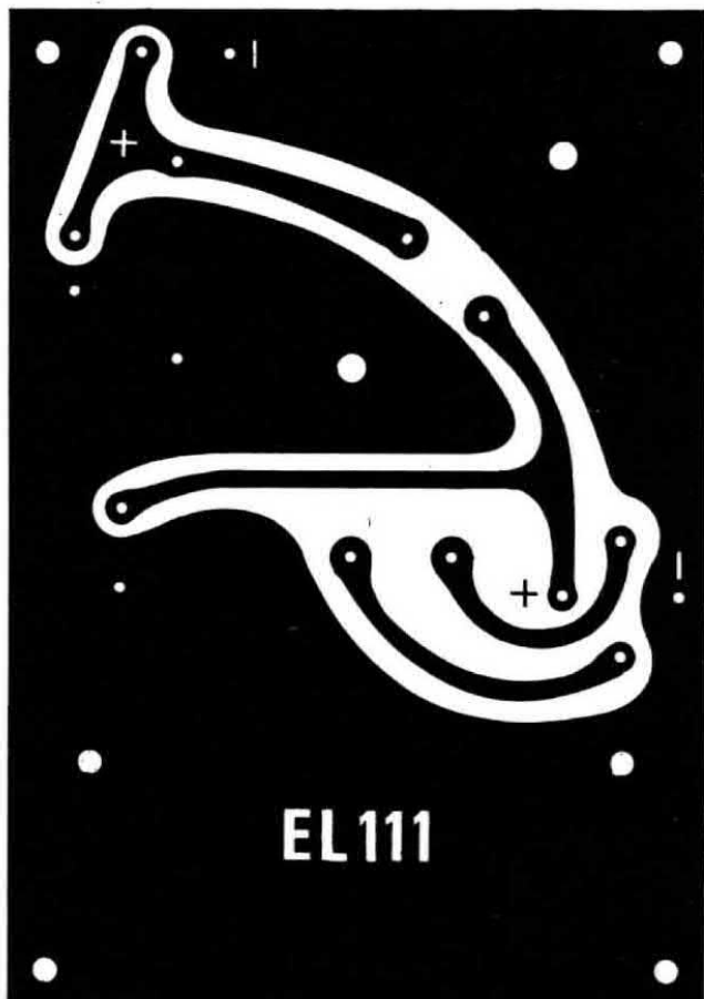
Fig. 5. Circuito stampato a grandezza naturale. Il lettore può richiedere alla nostra redazione il circuito già inciso su fibra di vetro al prezzo di L. 700 piú spese postali.
