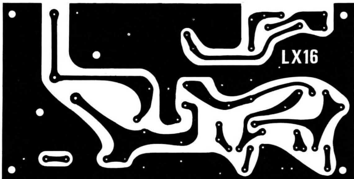
Fig. 12. Circuito stampato a grandezza naturale dello stadio alimentatore.
