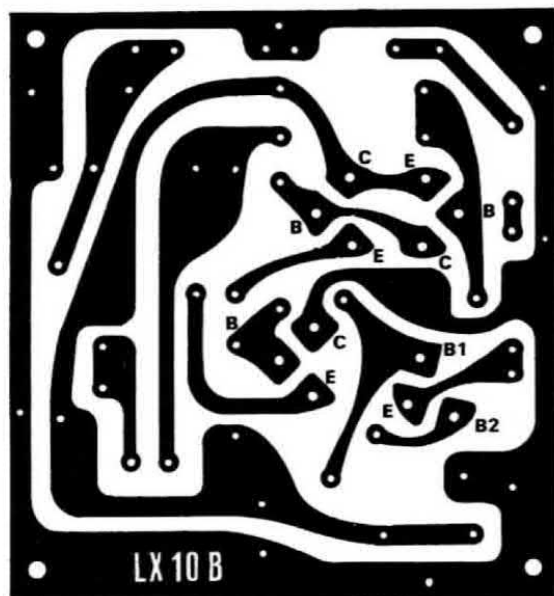
Fig. 6. Circuito stampato a grandezza naturale dello stadio finale di BF e del generatore di nota costituito dal transistor unigiunzione TR3.
