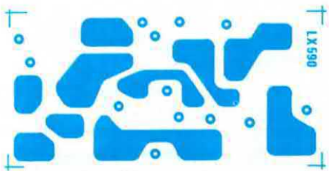
Fig. 2 Disegno a grandezza naturale del circuito stampato visto dal lato sul quale verranno collocati i componenti.
