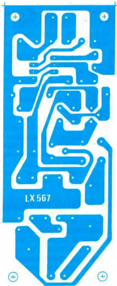
Fig. 7 Disegno a grandezza naturale del circuito stampato del trasmettitore ad onde convogliate. Come sempre il circuito vi verrà fornito già forato e completo di disegno serigrafico.
