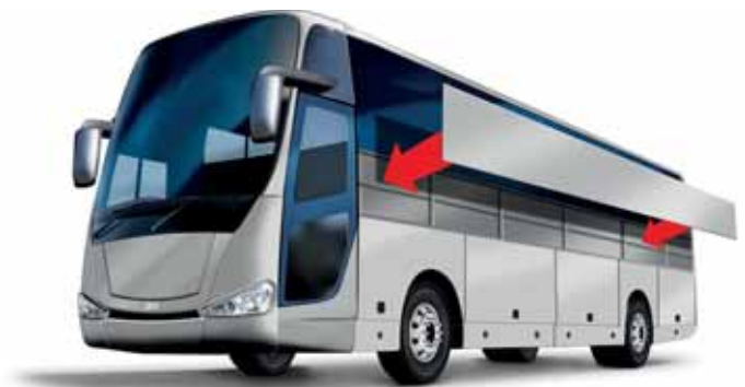
Verklebung von Karosserie-Anbauteilen
