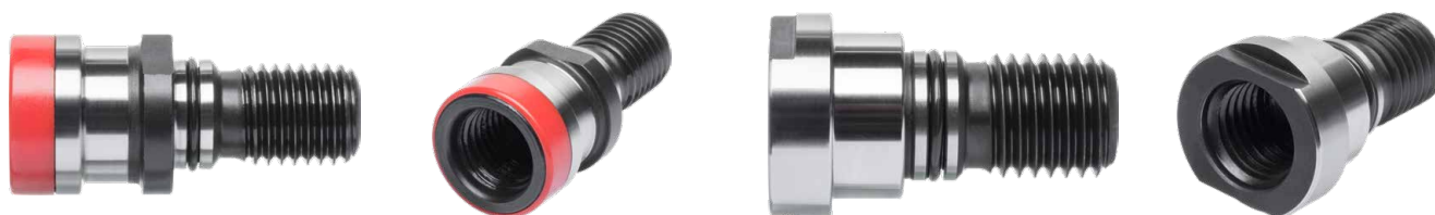
Bez.-Nr. 040 OTT Ringnut mit Innengewinde M16 und Bohrung \varnothing 7mm im Kopf für IK mit O-Ring für Werkzeugschaft DIN 69871 AD
