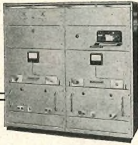
Fan Marker Beacon
