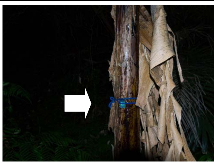
圖 17. 架設於野生芭蕉的微氣候記錄器，箭頭標示處為固定記錄器位置。
