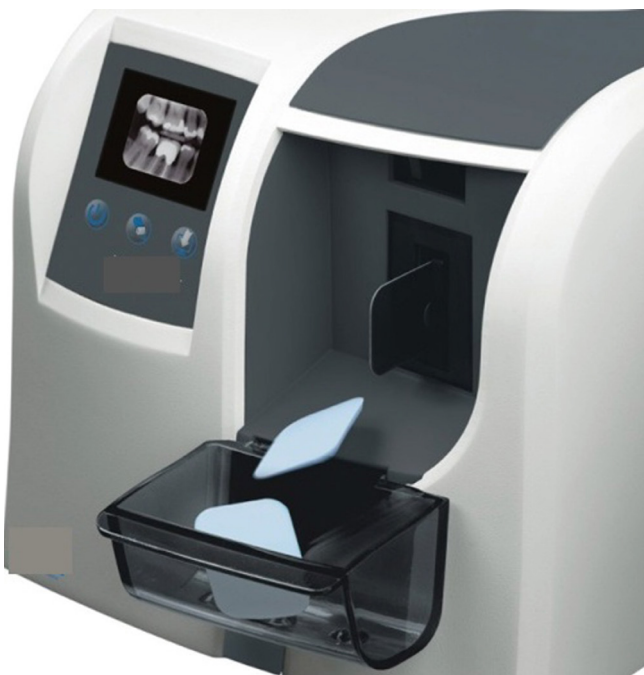
圖 164. 使用光激發磷光板和掃描儀之 CR 技術產生數位牙科影像的示例，可以使用電腦軟體進一步強化影像。
