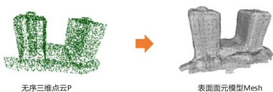
图5 点云表面面元模型重构效果示意图
