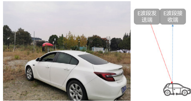
图 15 E 波段上的室外 ISAC 测试
