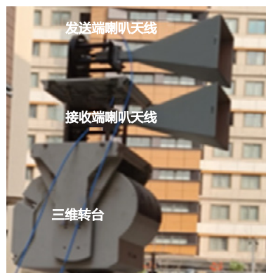
图 4 感知测量中模拟基站的收发机
