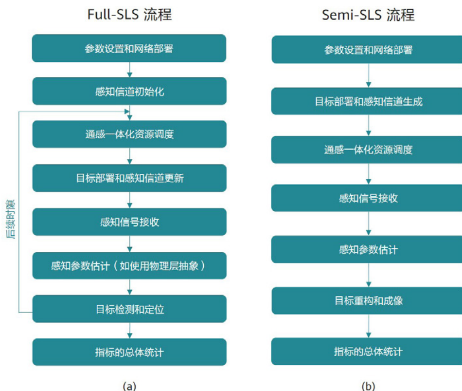
图 8 通感一体化评估的典型流程 (a) Full-SLS; (b) Semi-SLS
