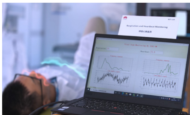
图 7 远程监控检测: ISAC 原型机
