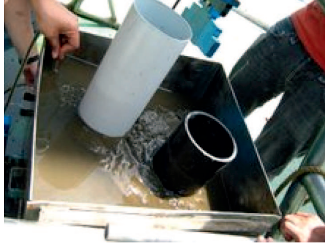
FIG. 3.6. Corer de caja y submuestreo con tubos de PVC. Fuente: A.C. Ruiz-Fernández (Universidad Nacional Autónoma de México).
