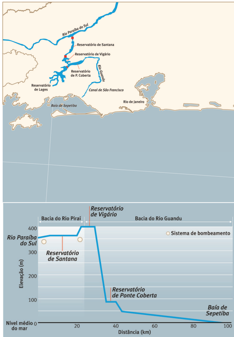
FIG. 9.16. Sistema de trasvase de las aguas del río Paraíba do Sul al río Guandú (Brasil). En rojo están las estaciones de bombeo. El gráfico indica la altitud vencida por las aguas en el proceso de transporte [8].
