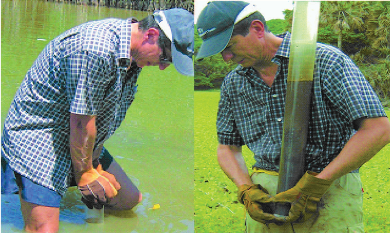
FIG. 3.2. Recolección manual de un core. En este caso se utiliza un tubo acrílico en un lugar somero (<1 m de profundidad de columna de agua). Fuente: A.C. Ruiz-Fernández (Universidad Nacional Autónoma de México).
