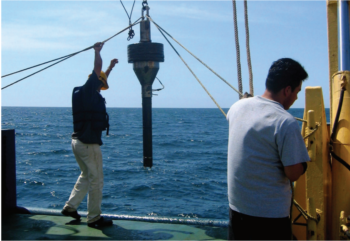
FIG. 3.4. Corer de gravedad simple. Fuente: A.C. Ruiz-Fernández (Universidad Nacional Autónoma de México).
