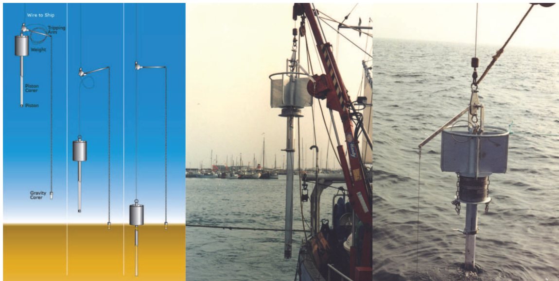
FIG. 3.3. Muestreador de pistón. Fuente: KC Denmark A/S, 2008.
