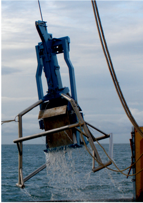
FIG. 3.6. Corer de caja y submuestreo con tubos de PVC. Fuente: A.C. Ruiz-Fernández (Universidad Nacional Autónoma de México).
