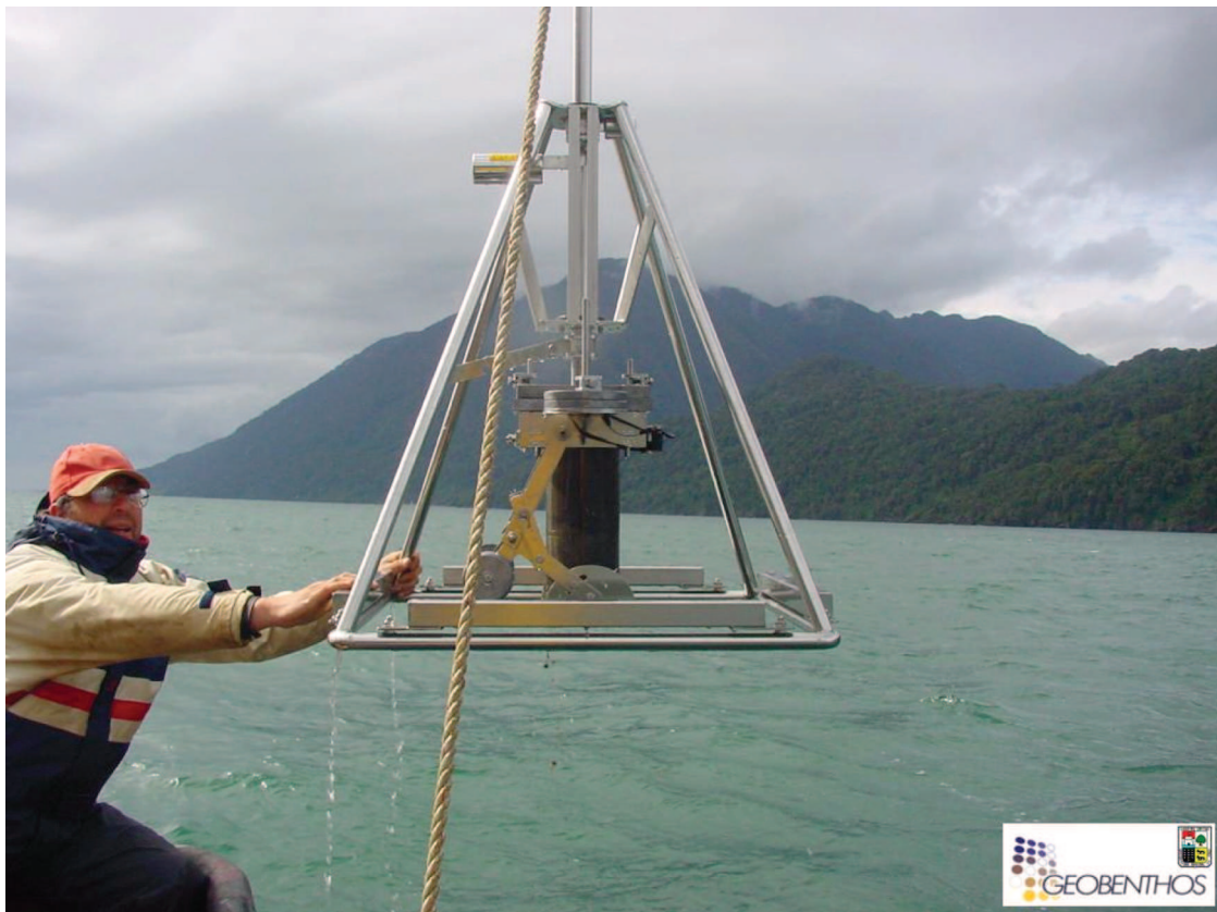
FIG. 3.7. HAPS corer. Fuente: S. Mulsow (Universidad Austral de Chile).
