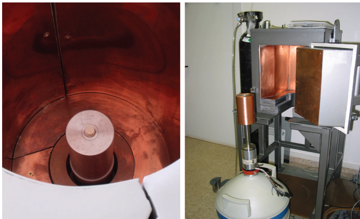
FIG. 4.2. Detectores de semiconductor de Ge. Izquierda: configuración de pozo. Fuente: A.C. Ruiz Fernández (Universidad Nacional Autónoma de México). Derecha: configuración coaxial. Fuente: J. García-Orellana (Universitat Autònoma de Barcelona).
