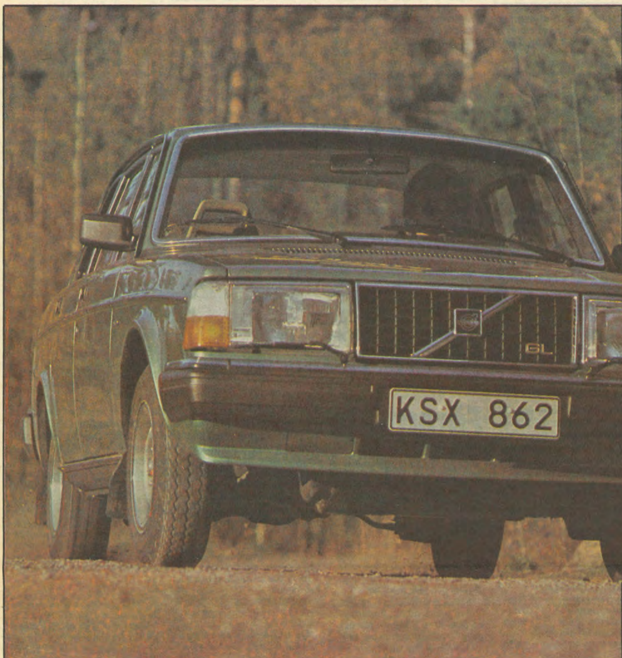
Stora Volvo har blivit kortare och smäckrare, sedan de tidigare gummiklädda stötfångarna bytts ut mot plastklädda sådana av mindre format. Resultatet är att totallängden har minskat med 9 cm.
