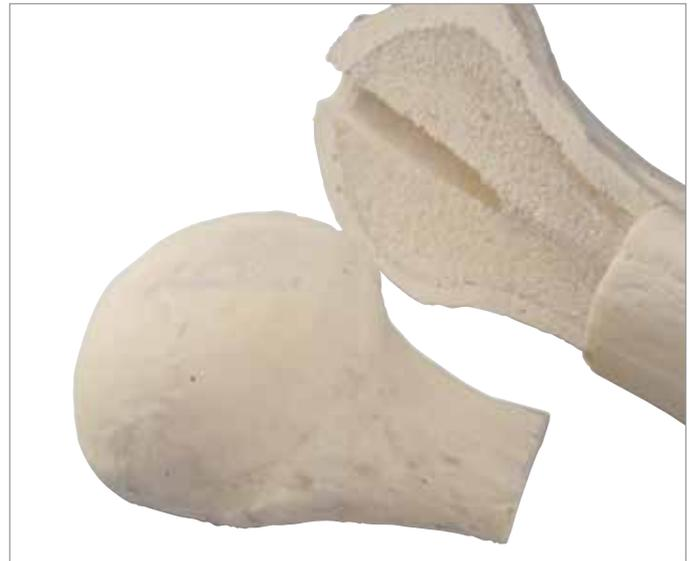
*Leur structure feuilletée simule l'os cortical dur et l'os spongieux plus mou. Des manipulations mécaniques (par exemple avec des vis, des plaques ou des implants) peuvent être pratiquées sur ces os d'atelier extrêmement réalistes.*
