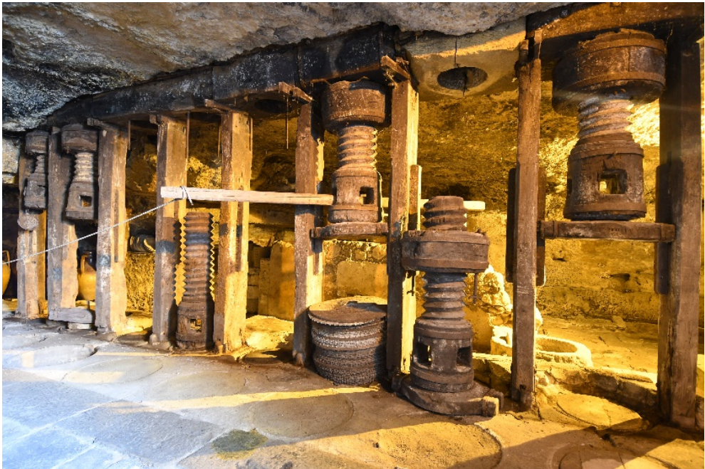
Figura 14. Grottaglie (TA). Trappeto Dormiente; batteria di torchi a una vite del tipo “alla genovese” (©A. Monte, 2018).
