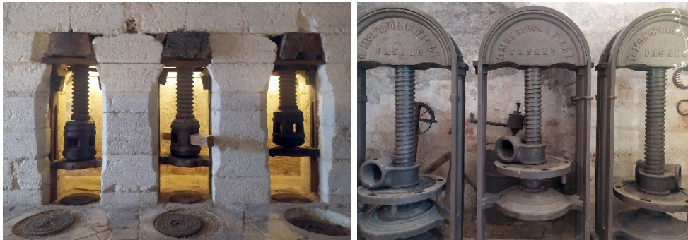
Figura 7. Fasano (BR). Trappeto della masseria San Lorenzo; torchi “alla genovese” e strettoj in ferro della ditta Leonardantonio Monopoli & Figli (©A. Ricci, 2020).
