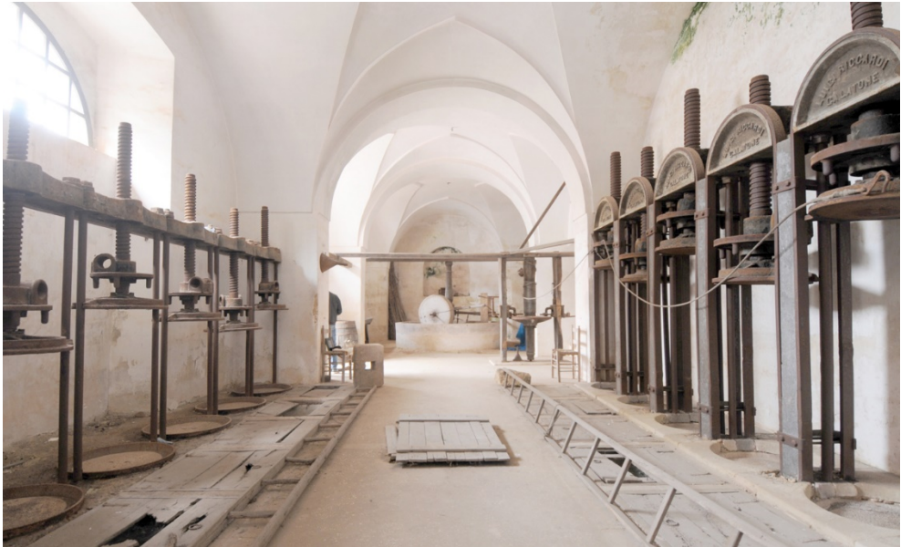
Figura 4. Patù (LE). Oleificio di Palazzo Pedone; frantoio e strettoj azionati con forza “animata” (©A. Monte, 2016).
