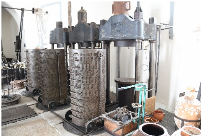
Figura 17. Andria (BT). Oleificio della tenuta Terre di Traiano; pressa idraulica a gabbia metallica (©A. Monte, 2017).
