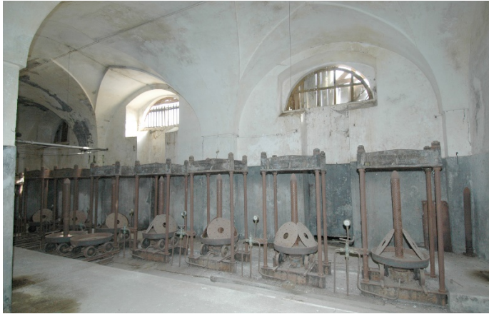
Figura 16. Ugento (LE). Oleificio Colosso; pressa idraulica a quattro colonne con guida centrale (©A. Monte, 2007).
