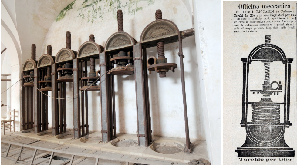
Figura 15. Patù (LE). Oleificio di Palazzo Pedone; strettoj a due colonne con movimento “a leva” semplice con stanga della Ditta Luigi Riccardi (©A. Monte, 2016).
