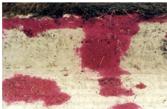
Figura 7. Vías de flujo preferencial (áreas rojas) en suelos arenosos homogéneos de dunas de Holanda. Foto tomada de Dekker (1998).
