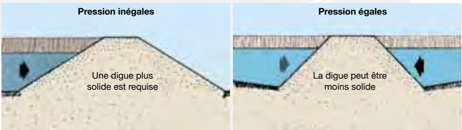
Figure 61. Différence de pression sur une digue.
