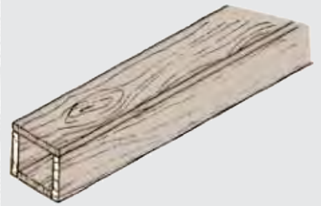
Figure 87. Canalisation en bois.
