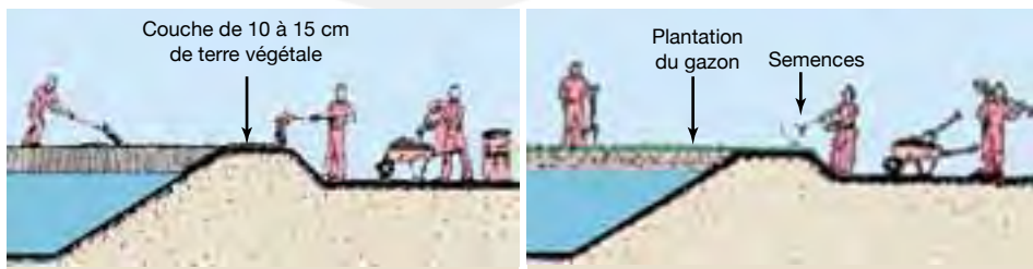
Figure 95. Mise en place d'un couvert végétal sur les digues.
