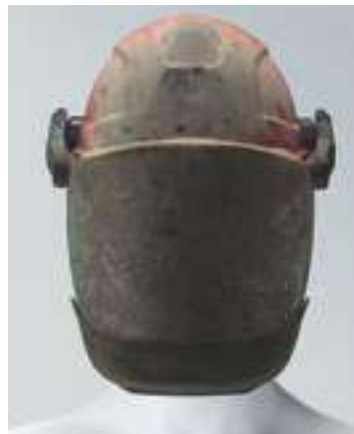
Nach 7 kA Störlichtbogen
