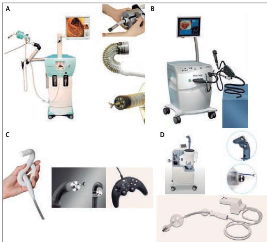
Figura 26.2. Endoscopios flexibles robotizados motorizados. A. Invendoscopy E200 System®. B. NeoGuide® colonoscope. C. Endotics System®. D. Aero-scope®.
