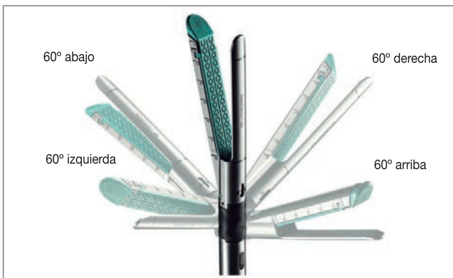
Figura 17.4. Angulación del grapado robótico, Sure From® para plataforma Da Vinci®.
