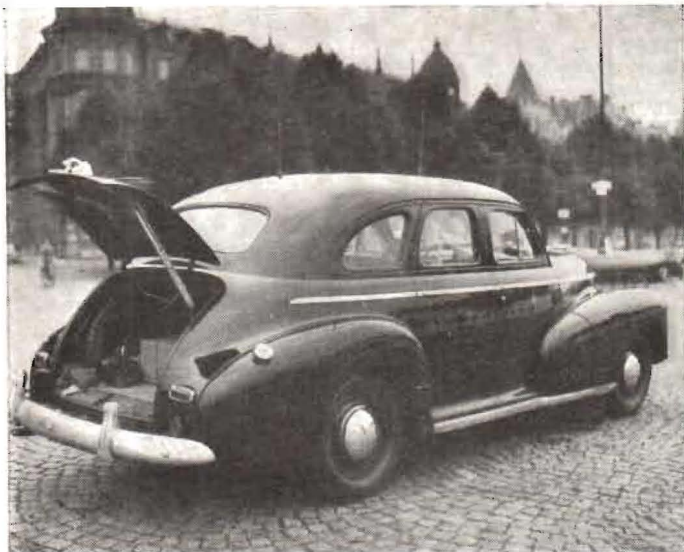
En av telegrafverkets provvagnar utrustad med radiotelefon. Observera de två små antennerna på bilens tak. Radio- och reläutrustningen är monterad i bilens bagageutrymme.
