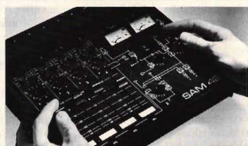
En svensk konstruktion: SAM 42 från SATT . Mixern har fyra in- och två utgångar.
