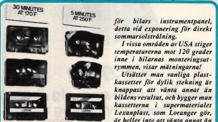
Den här samlingen illa brända, deformerade och kvaddade kompaktkassetter har utsatts för grymheter i miljötestkammare. De uppenbart opåverkade kassetterna längst ner är av Lorans fabrikat. Enligt den pr-byrå som tillställt RT bilden på uppdrag av klienten Loranger handlar resten om produkter från resp TDK, Maxell, Sony och BASF, fast etiketterna avlägsnats.
