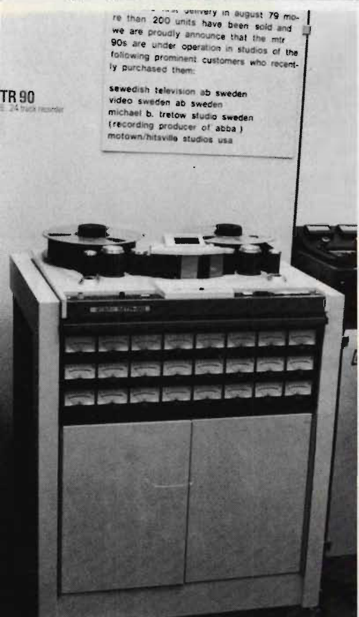
Otari tillverkar bla den här 24-kanaliga studiobandspelaren. Som kanske framgår av skylten ovanför har man flera svenska användare.
