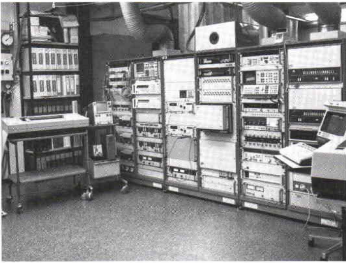
ATS 7 för provning av Jakt-Viggens flygradar på FFV i Arboga. Mikrovågstestaren ATS 2 för AJ 37.
