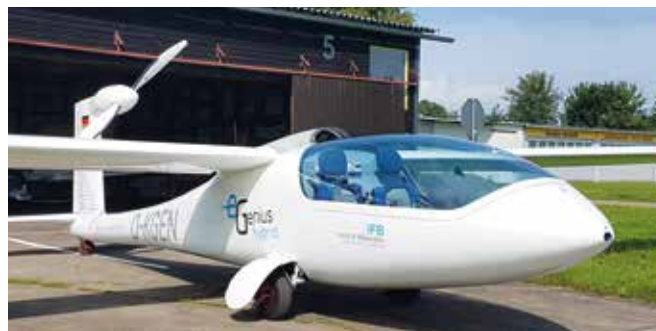
e-Genius Hybrid: deutlich erkennbar der Kühlluft einlauf kurz hinter der Kanzel
