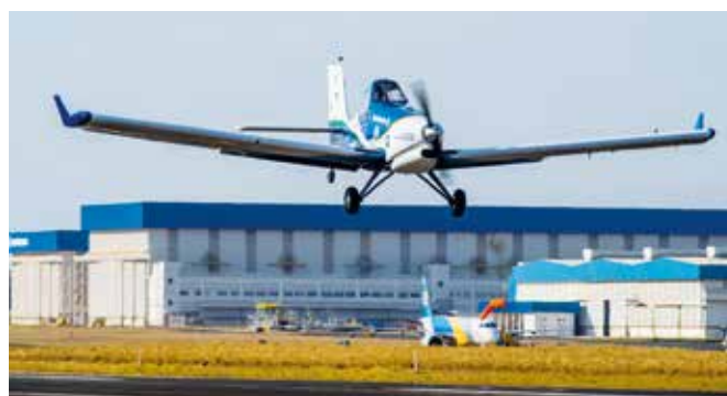
Die Embraer 203 ist eigentlich ein reines Agrarflugzeug. Dank seiner hohen Zuladung eignet es sich hervorragend als Technologieträger für neue Antriebe.
