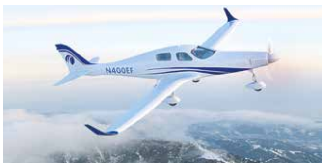
Ein schlanker Rumpf und Flügel mit hoher Streckung sind die äußeren Merkmale des neuen Viersitzers eFlyer 4. Angetrieben von einem 200 kW (268 PS) starken vollelektrischen Antriebssystem, richtet sich der eFlyer 4 an den Lufttaxi- und Schulungsmarkt.
