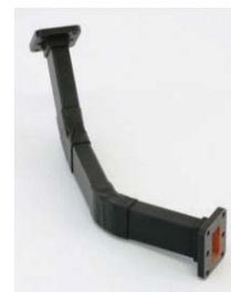
Guide d'onde 3D en CFRP métallisé par MOCVD
