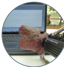
Spectromètre de terrain permettant d'effectuer des mesures de signatures spectrales de feuilles.
