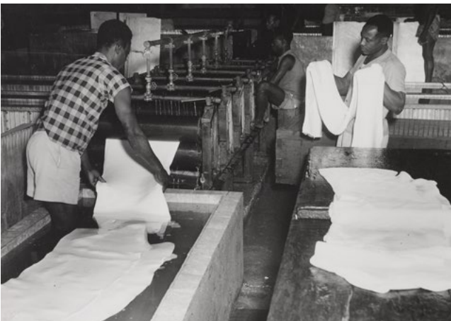
Dans une usine de caoutchouc à Yaleko dans le territoire d'Opala : après coagulation, les feuilles de caoutchouc sont calandrées pour en éliminer l'excès d'eau, en réduire l'épaisseur et en augmenter la surface. Elles seront ensuite fumées et séchées. (HP.1956.15.11000, collection MRAC Tervuren; photo C. Lamote [Inforcongo], © MRAC Tervuren.)
