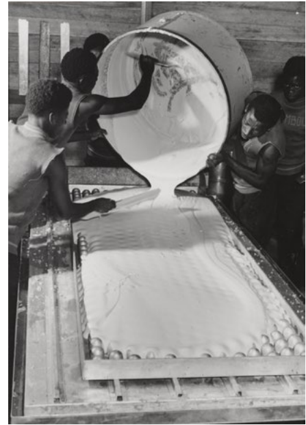
À Yanonge : le traitement du latex dans une usine fabriquant des articles en mousse de latex : le latex, auquel a été incorporé de l'acide formique, est versé dans des formes pour être vulcanisé. (HP.1956.15.11043, collection MRAC Tervuren; photo C. Lamote [Inforcongo], © MRAC Tervuren.)
