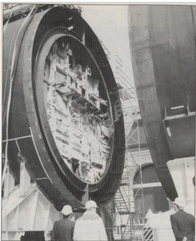
La découpe de la tranche réacteur donne une bonne idée des dimensions du premier SNLE français. Photo : DCN/Alain Bunel.
