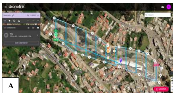
Figura 2. Etapas de la topografía fotogramétrica: planificación del vuelo planificación del vuelo (A), procesamiento de la nube de puntos (B), solapamiento de las imágenes (C) y resultado mostrado en entorno GIS-ArcGIS (D). El ejemplo observado corresponde con el sobrevuelo realizado al Mercado Sucre en Azogues.
