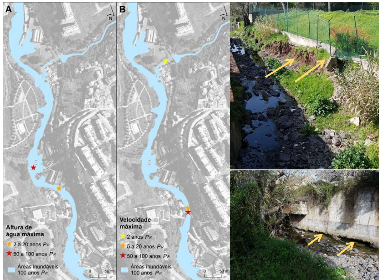
Figura 4. Localização dos valores máximos de altura de água (A) e velocidade (B). As setas assinalam o sapamento lateral onde são atingidas as velocidades máximas nas ribeiras de Massamá (2 anos P_R ) e Barcarena (5 a 100 anos P_R ).
