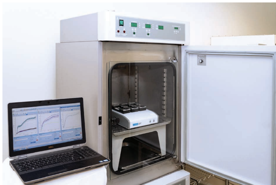
图 1. Agilent xCELLigence 仪器示意图。仪器置于标准培养箱中，与各种生物学相关温度、大气成分和湿度兼容。仪器由培养箱外放置的笔记本电脑控制
