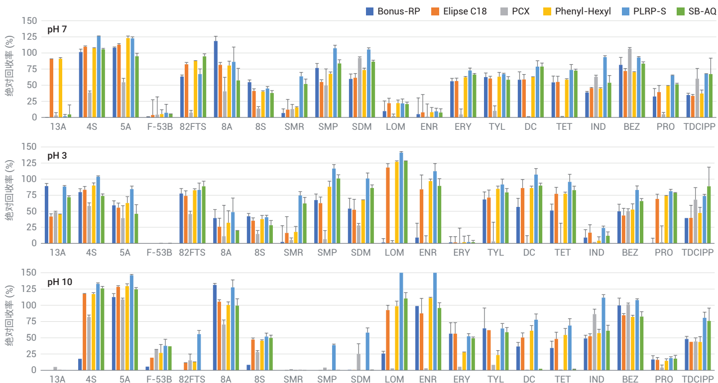
图 2. 3 种 pH 条件下, 代表性分析物在 6 种不同 SPE 小柱上的绝对回收率
