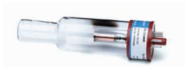
Figura 3. El punto negro visible en la lámpara Agilent es la zona de recogida activa creada deliberadamente para prolongar la vida útil de la lámpara y asegurar una pureza espectral continuada.
