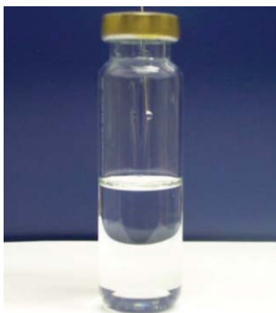
图 6.5 顶空单滴微萃取的配置
