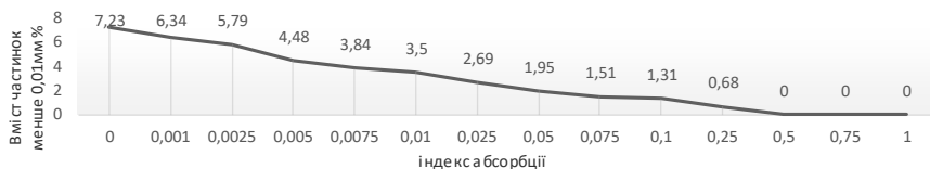
Рис. 2. Залежність даних вмісту часточок діаметром менше 0,01 мм від індексу абсорбції при використанні Mastersizer 3000E з Hydro EV
