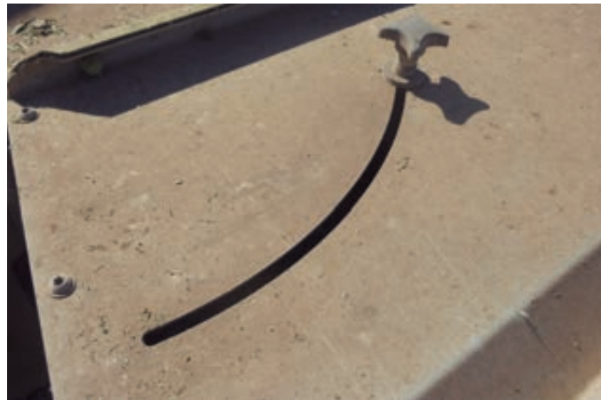
Foto 9. Muelle para la regulación de la oposición al paso del forraje entre los rodillos acondicionadores. Foto 10 (dcha). Regulador de la anchura del cordón de siega.
