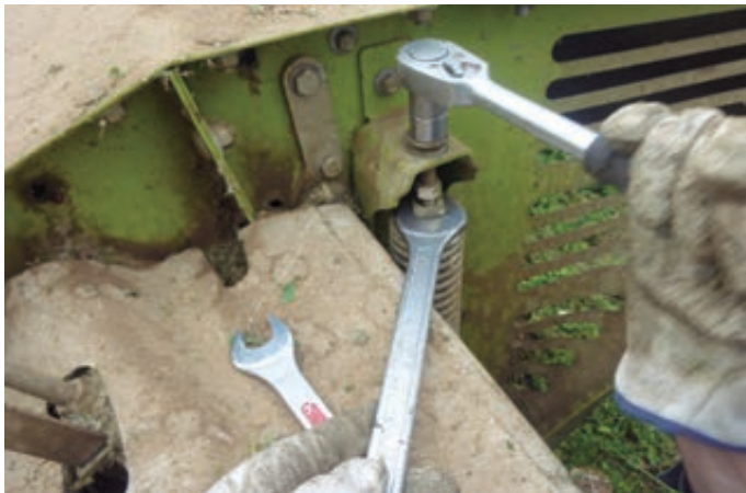
Foto 9. Muelle para la regulación de la oposición al paso del forraje entre los rodillos acondicionadores. Foto 10 (dcha). Regulador de la anchura del cordón de siega.
