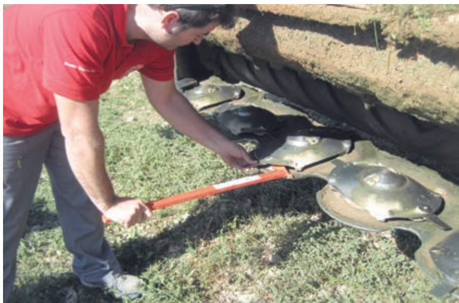
Foto 8. Cambio de cuchillas del disco de siega mediante llave específica.
