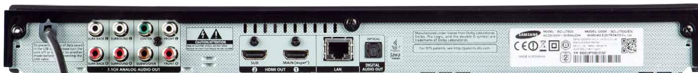
Das Spitzenmodell aus der aktuellen Samsung-Range verfügt standesgemäß über analoge Audio-Ausgänge sowie über eine zweite HDMI-Schnittstelle für separate Audio-Ausgabe
