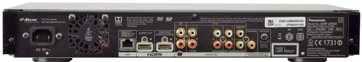
Neben zwei HDMI-Ausgängen (HDCP 2.2) bietet der UB900 auch analoge Ausgänge inklusive diskretem 7.1-Ton. Der kleine Lüfter im Gerät startet nur bei sporadisch und ist dabei relativ leise
