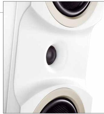
*Optisches Highlight und akustisch sinnvoll: Der Hochtöner der H 600 F wurde auf die akustische Ebene der Tiefmitteltöner zurückversetzt, dazu wurden Gehäusekanten sanft gerundet und minimieren somit störende Schallbrechung an harten Kanten und Ecken*
