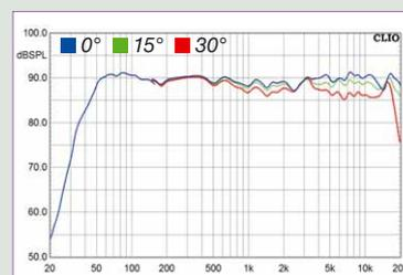
Die Vento 896 DC malt einen vorbildlich ausgewogen Frequenzgang ins Diagramm, auch abseits der Hauptachse.
