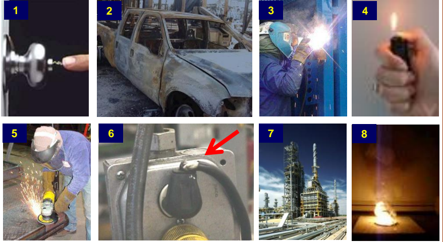
บางตัวอย่างของแหล่งที่ก่อให้เกิดประกายไฟ : (1) ฟ้าผ่าสถิตย์, (2) พายุหิมะ, (3) งานเชื่อม, (4) ไฟที่จุดขึ้นมา, (5) งานเจียร, (6) สายไฟที่ชำรุด, (7) เต้าเผา, (8) สารที่สลายตัวหรือติดไฟได้เองเมื่อสัมผัสกับอากาศ
