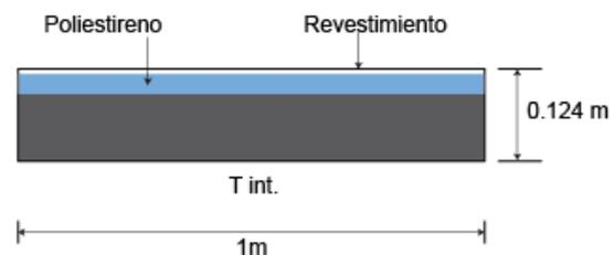
**Figura 10.** Cubierta compuesta
