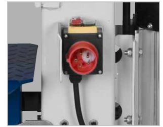
Schalter-Stecker-Kombination 400V/10A serienmäßig mit Phasenwender und Überlastschutz.
