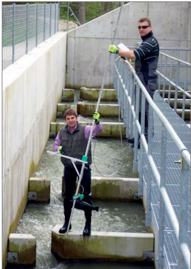
Foto 8. Küljejoonega varustatud sondiga mõõtmised hüdroelektrijaama kalapääsus Austrias. Jeffery Tuhtan ja Gert Toming biotehnoloogia keskusest.
