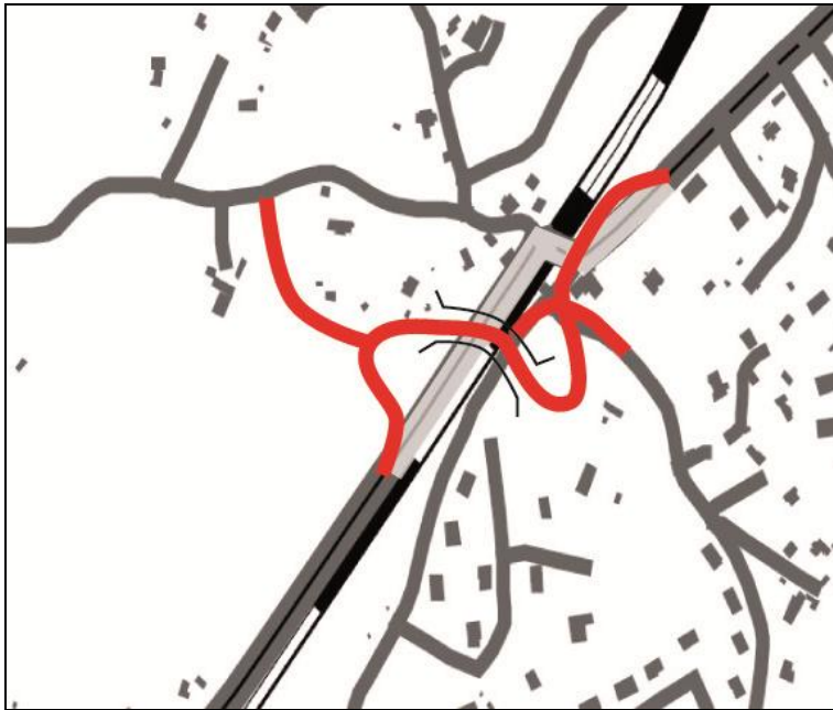
Figur 1 Idéskiss på planskildhet i form av en bro söder om dagens plankorsning.
