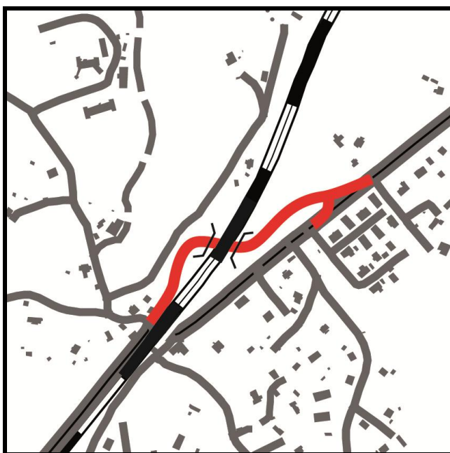
Figur 4 Idéskiss över hur en planskildhet i form av en tunnel strax norr om dagens plankorsning skulle kunna lösas.
