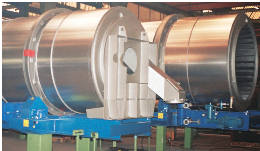
Die beiden fertig montierten Trockentrommeln mit acht und zehn Metern Länge sind Bestandteil zweier für China bestimmter Asphaltmischanlagen
