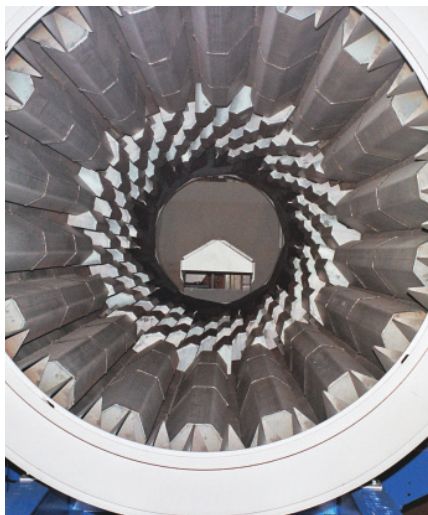
Innenansicht der 10 m langen und 3° nach unten geneigten Trockentrommel; die Ausrichtung der angeschraubten Schaufeln bestimmt die Drehrichtung
