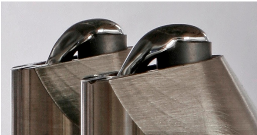
Abb. 16: Die Doppellötdüse halbiert die Taktzeit der Lötautomation
