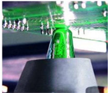
Abb. 14: Mini-Lötwellen, seitlich und rundum-abfließend
