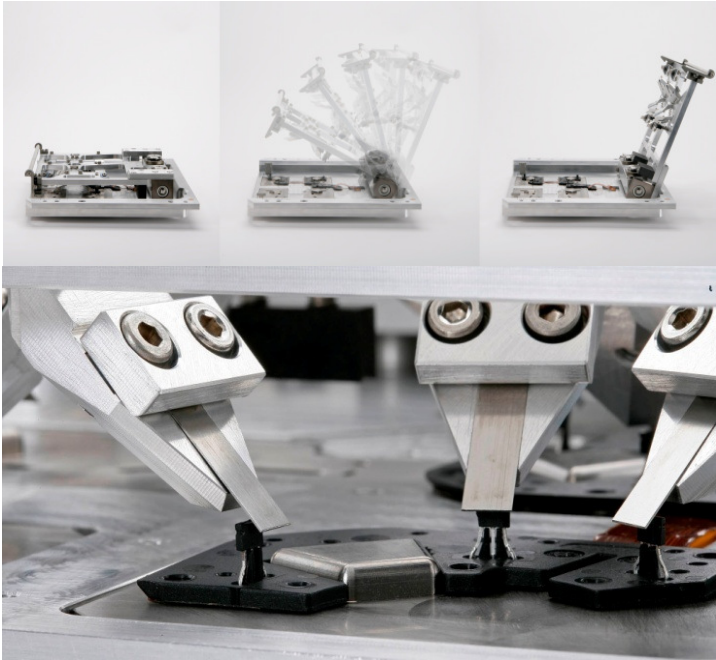
Abb. 49: Lötrahmen mit Niederhalter für Hallensoren
