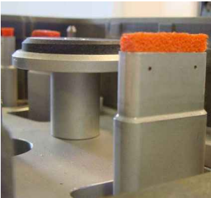
Abb. 47: Flussmittelauftrag durch Schwammfluxen
