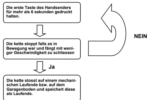
**Während der Wiedersynchronisierung wird das SENSE als geschlossene Position interpretiert. Um ungewünschten Betrieb zu vermeiden, wird die Empfindlichkeit stark reduziert.**
