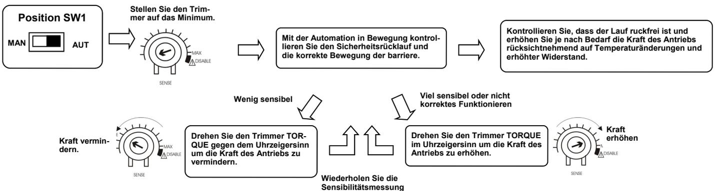
**Achtung:** Mit dem Trimmer auf Position **DISABLE** (Leuchtdiode an) ist die Funktion **Sicherheitsrücklauf** nicht aktiv.
