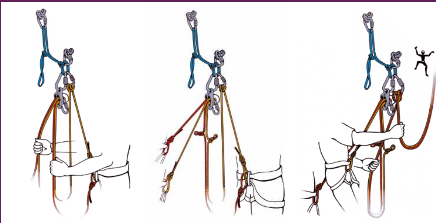
Die Nachsteiger werden mit Plate gesichert. Mitte: Die Plate und zwei Sackstichschlingen dienen den Nachsteigern als Selbstsicherung. Rechts: Der Vorsteiger wird im Zentralpunkt mittels HMS gesichert.
