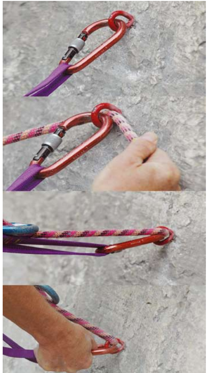
Ein sogenannter „Sigibolt“, der beim Unfall im Oktober 2005 ausriss
