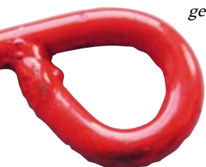
Ein sogenannter „Sigibolt“, der beim Unfall im Oktober 2005 ausriss
