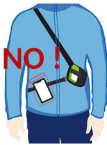
Abb. 7: Im Sendemodus: Handy nicht direkt auf/neben LVS-Gerät, sondern mind. 20 cm Abstand herstellen (verstauen in gegenüberliegender Hosentasche oder Rucksack) verhindert das Abschirmen des Signals bei Verschüttung.
