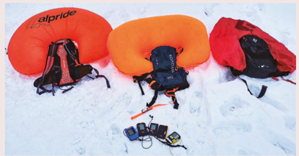
Abb. 1: Mit je einem LVS-Gerät pro Hersteller ( Mammut Barryvox S, Arva Neo BT Pro, Pieps Pro BT, BCA Tracker 4, Ortovox Direct Voice ) wurde der Einfluss elektronischer Airbag-Rucksäcke (im aktivierten, nicht-aufgeblasenen Zustand) und anderer Störquellen untersucht. Nicht abgebildet: Handy, GPS-Uhr, Funk, Heizhandschuh.
