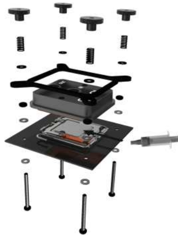
Montage des Kühlers auf eine Intel Socket 775 - 1156 CPU
