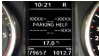
Display de los sensores de aparcamiento
