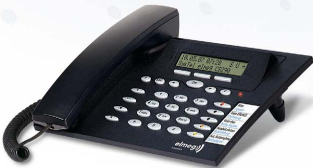
Fünf frei programmierbare Tasten mit LED-Unterstützung, teils zweifarbig, zeigen dem Benutzer jederzeit den Status wichtiger Funktionen. Diese Tasten können – wie bei den „großen“ elmeg-Systemtelefonen – z. B. als Linientaste, zur Schaltung von Rufumleitung, Headset- und Teamfunktionen, zur Bedienung eines externen Voice Mail-Systems oder zur MSN-Belegung genutzt werden.
