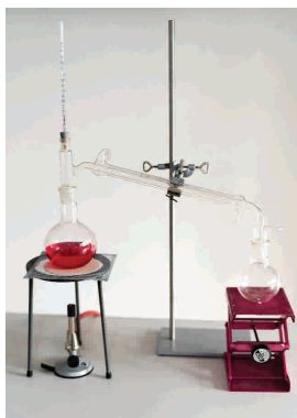
Destillationsapparatur (dargestellt ohne Schläuche für Kühlwasserabfluss und -zufluss) für z.B. die Gewinnung von hochprozentigem Ethanol
