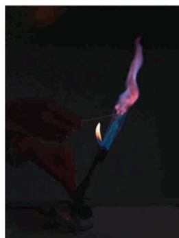
Flammenfärbung - grün: Kupferchlorid, rot: Strontiumchlorid, gelb: Natriumchlorid, violett: Kaliumchlorid
