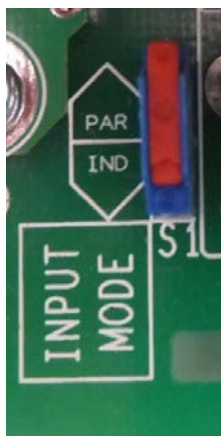
Figure 3-14: S1 Switch in PAR position (parallel mode)
