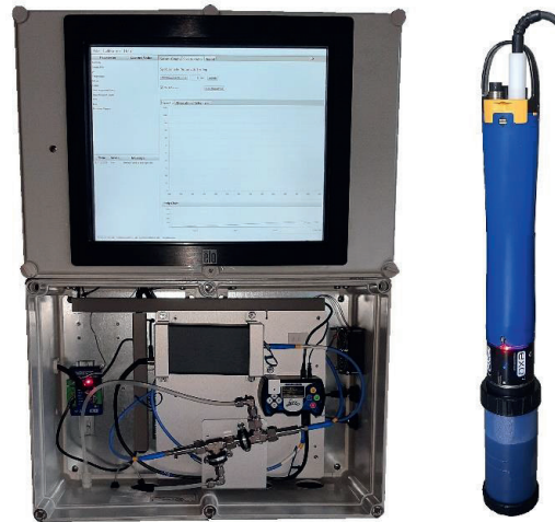
Abb. 1: TRITON-Wassersensor-System. Links oben: Computermodul. Links unten: Optisches Sensormodul. Rechts: Multiparametersonde Exo2 von YSI.
