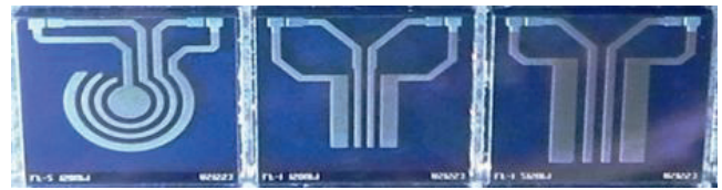
Abb. 3: Kapazitive Leitfähigkeitsstrukturen auf 5x5 mm 2 großen Chips
