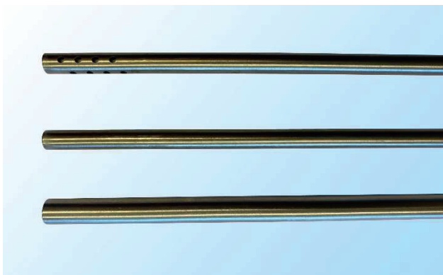
Abb. 1: Abbildung von drei Ausführungen von Widerstandsthermometern, oben – d = 6\text{mm} , durchbrochen (#1) Mitte – d = 6\text{mm} (#2) unten – d = 8\text{mm} (#3)
