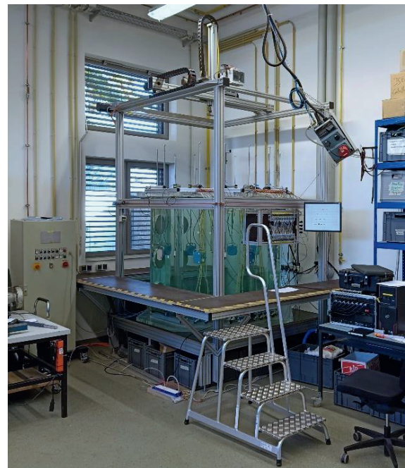
Abb. 2: Laborprüfstand inkl. Traversierung für das optische Vergleichsmesssystem, kontrollierter Begasung am Behälterboden mit Volumenstromüberwachung und akustischen Transducern für die GHATT
